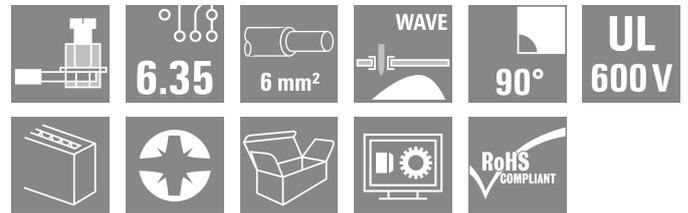
이 PCB 단자대(피치 6.35 mm, 입증된 클램프 결선 사용)의 특징: 1000 V, 32 A, 단면이 6 mm<sup>2</sup>인 전선 결선, 오프셋 솔더 핀, 90° 도체 아웃렛 방향.
