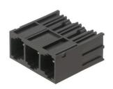
단층, 고성능 수형 헤더, 폴 손실이 없거나 공구 없이 빠른 고정을 위한 특허를 받은 플랜지를 사용한 병렬 장착용. 잘못된 결선을 방지하는 짝을 이루는 형태 덕분에 실현된 최대의 결선 및 작동 신뢰성과 특유의 다양한 코딩, 플랜지의 추가 조임. 3.5 mm 핀 길이는 웨이브 솔더링에 최적화되어 있으며, 플러그인 방향은 솔더 핀에 대해 270°입니다.
