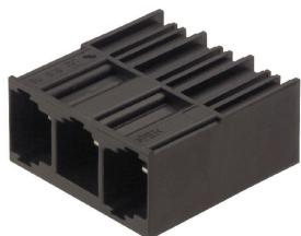
단층, 고전류 수형 헤더, 폴 손실이 없거나 공구 없이 빠른 잠금을 위한 특허 받은 플랜지를 사용한 병렬 장착용. 잘못된 결선을 방지하는 짹을 이루는 형태 덕분에 실현된 최대의 결선 및 작동 신뢰성과 특유의 다양한 코딩, 플랜지의 추가 조임. 3.5 mm 핀 길이는 웨이브 솔더링에 최적화되어 있으며, 플러그인 방향은 솔더 핀에 대해 90°입니다.
