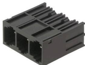
단층, 고성능 수형 헤더, 폴 손실이 없거나 공구 없이 빠른 고정을 위한 특허를 받은 플랜지를 사용한 병렬 장착용. 잘못된 결선을 방지하는 짹을 이루는 형태 덕분에 실현된 최대의 결선 및 작동 신뢰성과 특유의 다양한 코딩, 플랜지의 추가 조임. 3.5 mm 핀 길이는 웨이브 솔더링에 최적화되어 있으며, 플러그인 방향은 솔더 핀에 대해 270°입니다.
