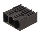
단층, 고전류 수형 헤더, 폴 손실이 없거나 공구 없이 빠른 잠금을 위한 특허 받은 플랜지를 사용한 병렬 장착용. 잘못된 결선을 방지하는 짝을 이루는 형태 덕분에 실현된 최대의 결선 및 작동 신뢰성과 특유의 다양한 코딩, 플랜지의 추가 조임. 3.5 mm 핀 길이는 웨이브 솔더링에 최적화되어 있으며, 플러그인 방향은 솔더 핀에 대해 90°입니다.
