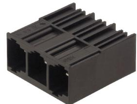
단층, 고전류 수형 헤더, 폴 손실이 없거나 공구 없이 빠른 잠금을 위한 특허 받은 플랜지를 사용한 병렬 장착용. 잘못된 결선을 방지하는 짹을 이루는 형태 덕분에 실현된 최대의 결선 및 작동 신뢰성과 특유의 다양한 코딩, 플랜지의 추가 조임. 3.5 mm 핀 길이는 웨이브 솔더링에 최적화되어 있으며, 플러그인 방향은 솔더 핀에 대해 90°입니다.
