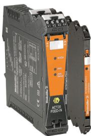
공급 전원의 공급과 분배를 분리하기 위한 전원 공급 어댑터: ACT20 시리즈/MICROSERIES 신호 컨버터용. 폭 22.5/6.1 mm의 전원 공급 모듈이 아날로그 신호 컨버터 주위에 직접 장착됩니다. 그런 다음 선택적으로 24 VDC 공급 전원이 CH20M(ACT20 시리즈) 레일 버스를 통해 브리지되거나 플러그형 ZOV 4N(MICROSERIES) 점프바를 사용하여 브리지됩니다.
