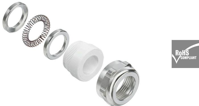
전자 콤포넌트의 감도가 높아지고 전자기 간섭 주파수가 늘어남에 따라 케이블 글랜드는 시스템의 차폐 측면에서 중요한 역할을 하고 있습니다. 이러한 유형의 EMC 케이블 글랜드는 360° 스크리닝 결선을 이용해 간섭 주파수로부터 차폐 기능을 발휘하도록 제작되었습니다. 핑거 록킹 씰이 탁월한 케이블 유지 및 스트레인 릴리프 기능을 제공하며, 그 옆의 케이블 글랜드는 EN 62444의 기계적 요구 사항을 충족합니다. 특히 받은 설계로 매우 간편하고 신속한 조립이 가능합니다.
