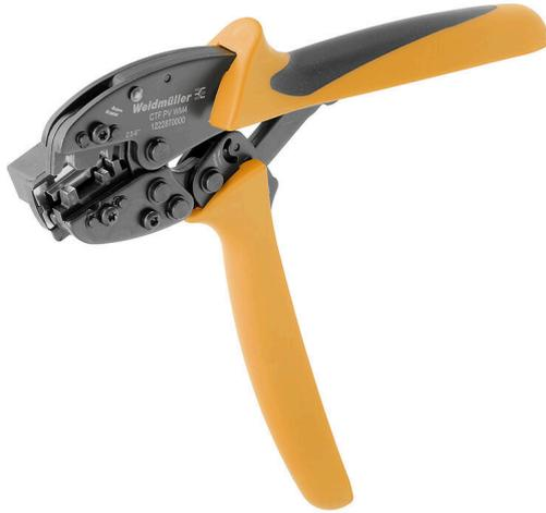
피복을 탈피한 후 적절한 접점(단자) 또는 페럴을 케이블 말단에 압착할 수 있습니다. 압착은 전선과 접점(단자) 간을 단단히 결선하기 위한 것으로, 솔더링을 대체하는 역할을 합니다. 압착은 전선과 결선 부품을 영구적으로 결선합니다. 결선 시에는 고품질의 정밀 공구를 사용해야 합니다. 그래야만 기계적, 전기적으로 확실하고 안정적으로 결선할 수 있습니다. 바이드물러에서는 광범위한 기계적 압착공구를 제공합니다. 릴리스 메커니즘을 활용하는 통합 라켓은 최적의 압착을 보장합니다. 바이드물러의 공구를 사용한 압착 결선은 국제 표준과 규정을 준수합니다.
