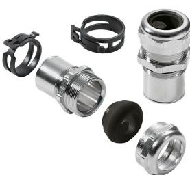
전자 콤포넌트의 감도가 높아지고 전자기 간섭 주파수가 늘어남에 따라 케이블 글랜드는 시스템의 차폐 측면에서 중요한 역할을 하고 있습니다. 이러한 유형의 EMC 케이블 글랜드는 360° 스크리닝 결선을 이용해 간섭 주파수로부터 차폐 기능을 발휘하도록 제작되었습니다. 핑거 롤링 씰이 탁월한 케이블 유지 및 스트레인 릴리프 기능을 제공하며, 그 옆의 케이블 글랜드는 EN 62444의 기계적 요구 사항을 충족합니다. 특히 받은 설계로 매우 간편하고 신속한 조립이 가능합니다.
