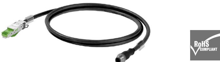
조립된 IE 라인, 철도 케이블 RW(Reduced Wire), cat. 5, PUR, 검은색, RJ45 플러그, 공구 불필요, IP20 및 M12
