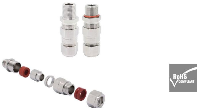
E1W 타입 케이블 글랜드는 SWA 강철 와이어 피복 케이블에 적합하며, E1W 타입 글랜드는 내염(Flameproof) Ex d 및 안전성 강화(Increased Safety) Ex e 방폭 기능을 제공합니다. 또한, 피복 클램핑은 케이블 피복과 글랜드 사이의 전기적 결합력을 제공합니다.
