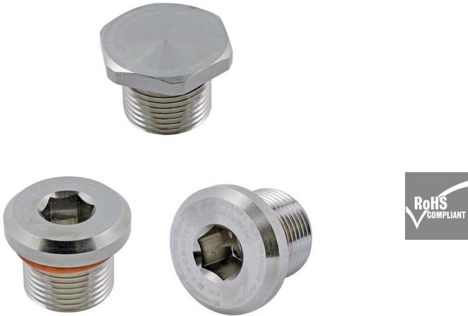
VP 시리즈 방폭 플러그는 Ex 장비에서 미사용 입력부를 채우는 용도로 사용되며, 내염(Flameproof) Ex d 및 안전성 강화(Increased Safety) Ex e 방폭 및 IP66/67/68 진입율을 유지합니다.
