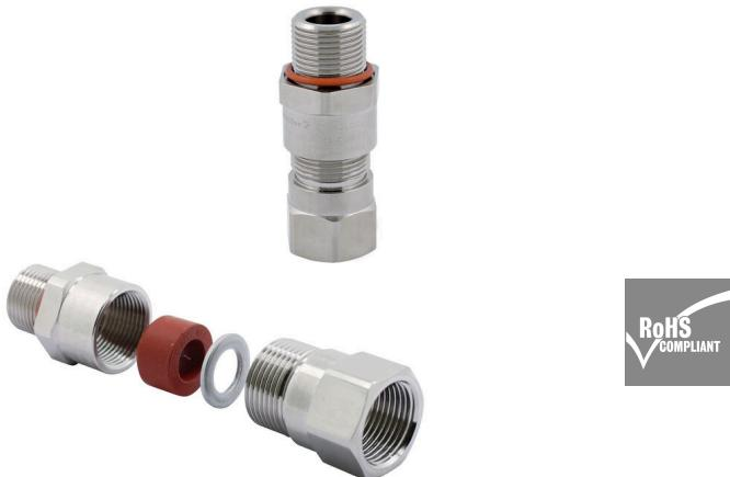
A2LC 타입 케이블 글랜드는 무피복 케이블에 적합한 제품으로 콘류잇 연결용 암형 스레드를 제공하며, 내염 (Flameproof) Ex d 및 안전성 강화(Increased Safety) Ex e 방폭 보호 기능을 제공합니다.
