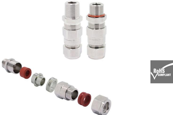
E1XZ 타입 케이블 글랜드는 SWB 편조 강철 와이어 또는 STA 강철 테이프 피복 케이블에 적합하며, E1XZ 타입 글랜드는 내염(Flameproof) Ex d 및 안전성 강화(Increased Safety) Ex e 방폭 기능을 제공합니다. 또한, 피복 클램핑은 케이블 피복과 글랜드 사이의 전기적 결합력을 제공합니다.
