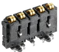
모듈방식 전자 장치 하우징 시스템을 위한 통합 레일 버스 모듈방식 애플리케이션 내에서 공급, 연결 또는 분배 시 레일 버스는 번거로운 개별 배선 공정을 유연하고 중단 없는 시스템 전체 솔루션으로 대체할 수 있습니다. 시스템 버스는 35-mm 표준 장착 레일 내에 안전하게 통합되어 있습니다. SMD-버스 접점 블록은 콤포넌트 조립 동안 완전히 자동으로 처리될 수 있도록 리플로우 슬더링될 수 있습니다. 내성이 있는 금 도금 접점 표면은 모든 하우징 쪽에서 영구적이고 신뢰할 수 있는 접점을 보장합니다.
