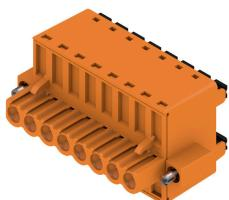
고성능 시그널 버스 응용을 위한 강력한 데이터 채인 방식의 솔루션은 또한 18.5 A 전류 용량의 400 V 보조 전력 채인에 적합합니다. 큰 클램핑 용량(최대 2.5 mm<sup>2</sup> 와이어 단면)은 낮은 전압 강하로 인해 긴 버스 케이블 또는 고전류에 특히 유리합니다.
