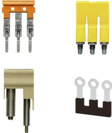
인접한 단자대에 전위를 분배 또는 증가시키는 것은 교차 연결을 통해 구현됩니다. 추가적인 결선 노력은 쉽게 피할 수 있습니다. 풀이 분리되더라도 단자대 블록의 점접 안정성은 여전히 보장됩니다. 당사의 포트폴리오는 모듈형 터미널 블록을 위한 플러그형 및 스크루형 점프바 시스템을 제공합니다.
