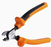
최대 외경 8 mm, 12 mm, 14 mm 및 22 mm 컨덕터용 절단 공구. 블레이드의 특수 기하학적 구조로 인해 최소한의 물리적 힘으로 구리 및 알루미늄 컨덕터를 핀칭 없이 절단할 수 있습니다. 이 절단 공구(KT 8~KT 22)는 VDE 및 GS 시험을 통과한 EN/IEC 60900 규격의 보호 절연(최대 1,000V)도 제공합니다.
