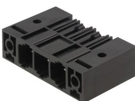
IEC 61800-5-1에 따른 400-V IT 시스템용 10.16 피치의 중간 솔더 플랜지 조임 기능이 있는 메일 헤더. 리딩 접점 사용 시 UL840(600 V) 규격 UL 인증. BUZ 10.16 IT와 함께 사용 시, IT 시스템(접지 대비 400 V)의 5.5mm 접촉 안전성에 대해 IEC 61800-5-1에 따른 강화된 요건을 충족합니다. 중간 플랜지 인터록 기능으로 다른 표준 솔루션들에 비해 필요 공간이 1피치 폭만큼 절약됩니다. 요청 시 스크류 플랜지 포함 또는 미포함으로 제공 가능합니다.
