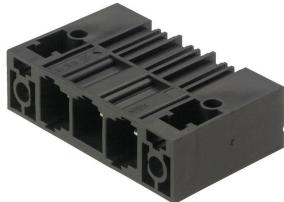
단층, 고전류 수형 헤더, 폴 손실이 없거나 공구 없이 빠른 잠금을 위한 특허 받은 플랜지를 사용한 병렬 장착용. 잘못된 결선을 방지하는 짹을 이루는 형태 덕분에 실현된 최대의 결선 및 작동 신뢰성과 특유의 다양한 코딩, 플랜지의 추가 조임. 3.5 mm 핀 길이는 웨이브 솔더링에 최적화되어 있으며, 플러그인 방향은 솔더 핀에 대해 90°입니다.
