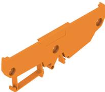
RS 100 Profi는 DIN 레일 설치와 벽면 설치가 모두 가능하기 때문에, 설치 요구 사항에 맞는 유연한 솔루션을 제공합니다. 이러한 다재다능함 덕분에 다양한 환경과 애플리케이션에 쉽게 통합할 수 있습니다. 하우징은 유로카드 PCB 표준을 따릅니다. 프로파일을 원하는 크기로 잘라내어 특정 요건에 정확하게 맞출 수 있습니다. 특히 무거운 부품의 경우, 추가적인 잠금 다리를 사용하여 안정성을 높이고 설치의 안전성을 높일 수 있습니다. 또 다른 실용적인 기능은 커버 프로파일을 사용하여 큰 컴포넌트를 보호하는 옵션입니다.
