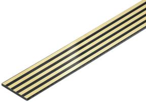
모듈방식 전자 장치 하우징 시스템을 위한 통합 레일 버스 모듈방식 애플리케이션 내에서 공급, 연결 또는 분배 시 레일 버스는 번거로운 개별 배선 공정을 유연하고 중단 없는 시스템 전체 솔루션으로 대체할 수 있습니다. 시스템 버스는 35-mm 표준 장착 레일 내에 안전하게 통합되어 있습니다. SMD-버스 접점 블록은 콤포넌트 조립 동안 완전히 자동으로 처리될 수 있도록 리플로우 솔더링될 수 있습니다. 내성이 있는 금 도금 접점 표면은 모든 하우징 쪽에서 영구적이고 신뢰할 수 있는 접점을 보장합니다.
