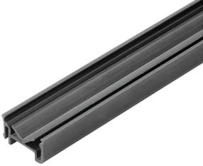
모듈방식 전자 장치 하우징 시스템을 위한 통합 레일 버스 모듈방식 애플리케이션 내에서 공급, 연결 또는 분배 시 레일 버스는 번거로운 개별 배선 공정을 유연하고 중단 없는 시스템 전체 솔루션으로 대체할 수 있습니다. 시스템 버스는 35-mm 표준 장착 레일 내에 안전하게 통합되어 있습니다. SMD-버스 접점 블록은 콤포넌트 조립 동안 완전히 자동으로 처리될 수 있도록 리플로우 솔더링될 수 있습니다. 내성이 있는 금 도금 접점 표면은 모든 하우징 쪽에서 영구적이고 신뢰할 수 있는 접점을 보장합니다.
