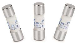
gPV 원통형 퓨즈 카트리지는 최대 전압 1,500 DC의 광전지 모듈(현장 보호)에 대해 컴팩트하고 안전하며, 경제적인 보호를 제공할 수 있도록 설계된 제품입니다. 과부하와 단락 보호를 모두 제공합니다(IEC60269-6 및 UL248-19 표준 요건에 따른 gPV 클래스). 높은 내부 압력과 열충격 내성을 가진 세라믹 튜브로 만들어져 좁은 공간에서도 높은 스위칭 용량을 갖습니다. 점점은 노화를 방지해 전기적 특성이 일정하게 유지되도록 하기 위해 은도금 구리와 순은의 가용성 요소로 만들었습니다. 10x38mm, 10x85mm, 22x58mm 사이즈로 점점은 사용할 수 있습니다.
