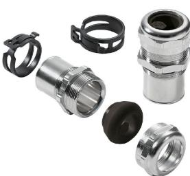
전자 콤포넌트의 감도가 높아지고 전자기 간섭 주파수가 늘어남에 따라 케이블 글랜드는 시스템의 차폐 측면에서 중요한 역할을 하고 있습니다. 이러한 유형의 EMC 케이블 글랜드는 360° 스크리닝 결선을 이용해 간섭 주파수로부터 차폐 기능을 발휘하도록 제작되었습니다. 핑거 록킹 씰이 탁월한 케이블 유지 및 스트레인 릴리프 기능을 제공하며, 그 옆의 케이블 글랜드는 EN 62444의 기계적 요구 사항을 충족합니다. 특히 받은 설계로 매우 간편하고 신속한 조립이 가능합니다.
