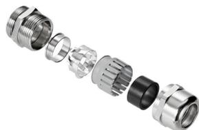
전자 콤포넌트의 감도가 높아지고 전자기 간섭 주파수가 늘어남에 따라 케이블 글랜드는 시스템의 차폐 측면에서 중요한 역할을 하고 있습니다. 이러한 유형의 EMC 케이블 글랜드는 360° 스크리닝 결선을 이용해 간섭 주파수로부터 차폐 기능을 발휘하도록 제작되었습니다. 핑거 록킹 씰이 탁월한 케이블 유지 및 스트레인 릴리프 기능을 제공하며, 그 옆의 케이블 글랜드는 EN 62444의 기계적 요구 사항을 충족합니다. 특히 받은 설계로 매우 간편하고 신속한 조립이 가능합니다.
