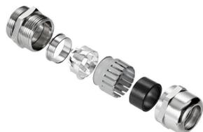
전자 콤포넌트의 감도가 높아지고 전자기 간섭 주파수가 늘어남에 따라 케이블 글랜드는 시스템의 차폐 측면에서 중요한 역할을 하고 있습니다. 이러한 유형의 EMC 케이블 글랜드는 360° 스크리닝 결선을 이용해 간섭 주파수로부터 차폐 기능을 발휘하도록 제작되었습니다. 핑거 록킹 씰이 탁월한 케이블 유지 및 스트레인 릴리프 기능을 제공하며, 그 옆의 케이블 글랜드는 EN 62444의 기계적 요구 사항을 충족합니다. 특히 받은 설계로 매우 간편하고 신속한 조립이 가능합니다.
