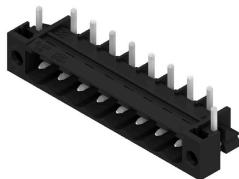
내열성, 직선, 개방형 끝단의 핀 헤더. 박스 또는 테이프 포장. 자동 조립에 최적화된 1.5 mm 용접 핀의 테이프 형태. 리플로우 및 웨이브 용접에 적합한 3.2 mm 솔더 핀. 핀 헤더는 라벨링을 위한 공간을 제공하며 코딩이 가능합니다. HC = 고전류
