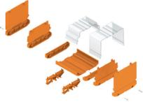
RS 100 Profi는 DIN 레일 설치와 벽면 설치가 모두 가능하기 때문에, 설치 요구 사항에 맞는 유연한 솔루션을 제공합니다. 이러한 다재다능함 덕분에 다양한 환경과 애플리케이션에 쉽게 통합할 수 있습니다. 하우징은 유로카드 PCB 표준을 따릅니다. 프로파일을 원하는 크기로 잘라내어 특정 요건에 정확하게 맞출 수 있습니다. 특히 무거운 부품의 경우, 추가적인 잠금 다리를 사용하여 안정성을 높이고 설치의 안전성을 높일 수 있습니다. 또 다른 실용적인 기능은 커버 프로파일을 사용하여 큰 콤포넌트를 보호하는 옵션입니다.
