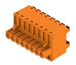
고성능 시그널 버스 응용을 위한 강력한 데이지 체인 방식의 솔루션은 또한 18.5 A 전류 용량의 400 V 보조 전력 체인에 적합합니다. 큰 클램핑 용량(최대 2.5 mm² 와이어 단면)은 낮은 전압 강하로 인해 긴 버스 케이블 또는 고전류에 특히 유리합니다.
