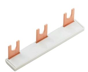
인접한 단자대에 전위를 분배 또는 증가시키는 것은 교차 연결을 통해 구현됩니다. 추가적인 결선 노력은 쉽게 피할 수 있습니다. 풀이 분리되더라도 단자대 블록의 점접 안정성은 여전히 보장됩니다. 당사의 포트폴리오는 모듈형 터미널 블록을 위한 플러그형 및 스크류형 점프바 시스템을 제공합니다.
