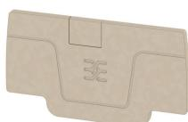
종판과 앤드 플레이트는 단자대의 필수 부속품입니다. 종판은 서로 다른 전위와 기능 그룹을 광학적으로 및 전기적으로 분리하여 안전성을 높이고 배전반 내부의 명확한 구조를 보장합니다. 앤드 플레이트는 측면의 단자대 열을 마감하고, 전류가 흐르는 부품과의 접촉을 방지하며, 깔끔하고 안정적인 마감을 보장합니다. 두 부품 모두 각각의 바이드클러 단자대 시리즈에 정확히 대응되어 안전하고 규정을 준수하며 전문적인 배선에 기여합니다.
