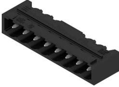
내열성 핀 헤더, 상자 또는 테이프로 포장됨. 자동 조립에 최적화된 1.5 mm 용접 핀의 테이프 형태. 리플로우 및 웨이브 용접에 적합한 3.2 mm 슬더 핀. 핀 헤더는 라벨링을 위한 공간을 제공하며 코딩이 가능합니다. HC = 고전류
