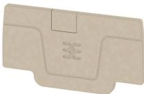
종판과 엔드 플레이트는 단자대의 필수 부속품입니다. 종판은 서로 다른 전위와 기능 그룹을 광학적으로 및 전기적으로 분리하여 안전성을 높이고 배전반 내부의 명확한 구조를 보장합니다. 엔드 플레이트는 측면의 단자대 열을 마감하고, 전류가 흐르는 부품과의 접촉을 방지하며, 깔끔하고 안정적인 마감을 보장합니다. 두 부품 모두 각각의 바이드몰러 단자대 시리즈에 정확히 대응되어 안전하고 규정을 준수하며 전문적인 배선에 기여합니다.
