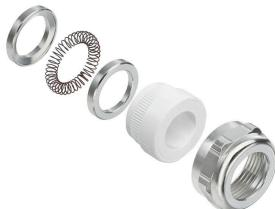
전자 콤포넌트의 감도가 높아지고 전자기 간섭 주파수가 늘어남에 따라 케이블 글랜드는 시스템의 차폐 측면에서 중요한 역할을 하고 있습니다. 이러한 유형의 EMC 케이블 글랜드는 360° 스크리닝 결선을 이용해 간섭 주파수로부터 차폐 기능을 발휘하도록 제작되었습니다. 핑거 록킹 씰이 탁월한 케이블 유지 및 스트레인 릴리프 기능을 제공하며, 그 옆의 케이블 글랜드는 EN 62444의 기계적 요구 사항을 충족합니다. 특히 받은 설계로 매우 간편하고 신속한 조립이 가능합니다.
