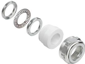
전자 컴포넌트의 감도가 높아지고 전자기 간섭 주파수가 늘어남에 따라 케이블 글랜드는 시스템의 차폐 측면에서 중요한 역할을 하고 있습니다. 이러한 유형의 EMC 케이블 글랜드는 360° 스크리닝 결선을 이용해 간섭 주파수로부터 차폐 기능을 발휘하도록 제작되었습니다. 핑거 록킹 씰이 탁월한 케이블 유지 및 스트레인 릴리프 기능을 제공하며, 그 옆의 케이블 글랜드는 EN 62444의 기계적 요구 사항을 충족합니다. 특히 받은 설계로 매우 간편하고 신속한 조립이 가능합니다.
