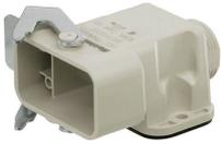
금형 주조한 특수 합금과 멀티 레이어 표면 실링 처리가 HDC 하우징을 완벽하게 보호합니다. 빈틈없이 설계된 인터록 시스템은 스테인리스 스틸로 제작되었습니다. 따라서 제품 수명이 길 뿐만 아니라 부식과 충격에 강합니다. 하우징 인터록 시스템은 통합 안전을 제공합니다. 특허를 받은 바이드물러의 고유한 스프링 시스템은 하우징 인터록에 안전한 그림감을 제공하고 인터록 시스템이 실수로 열리지 않도록 방지합니다. 레이저 마킹을 활용하면 쉽고 빠르게 마킹할 수 있습니다. 각 하우징 제품을 신속하게 지정하고 배치할 수 있도록 레이저 마킹을 통해 각 하우징을 영구적으로 라벨링합니다. 바이드물러 RockStar® IP 65 / NEMA 타입 4X 하우징 - IP 65 보호 등급의 산업용 하우징을 위한 1차적 선택. 이제 HQ 버전은 특별한 보호를 제공합니다. 즉, 벌크헤드 하우징 (커버 및 금속 클램프)을 패드록으로 고정할 수 있습니다..
