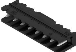
90° 각도의 내고온 개방형 수형 헤더 박스 또는 테이프 포장. 자동 조립에 최적화된 1.5 mm 용접 핀의 테이프 형태. 리플로우 및 웨이브 용접에 적합한 3.2 mm 솔더 핀. 핀 헤더는 라벨링을 위한 공간을 제공하며 코딩이 가능합니다. HC = 고전류
