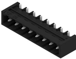
내열성, 직선, 개방형 끝단의 핀 헤더. 박스 또는 테이프 포장. 자동 조립에 최적화된 1.5 mm 용접 핀의 테이프 형태. 리플로우 및 웨이브 용접에 적합한 3.2 mm 슬더 핀. 핀 헤더는 라벨링을 위한 공간을 제공하며 코딩이 가능합니다. HC = 고전류
