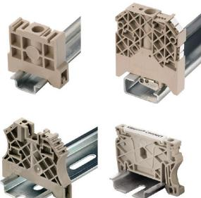
바이드풀러 제품군에는 단자대 레일에 영구적이고 안정적으로 마운트될 수 있도록 보장하고 미끄러짐을 방지하는 엔드 브래킷이 포함되어 있습니다. 스크류가 포함 또는 포함되지 않은 버전을 사용할 수 있습니다. 엔드 브래킷에는 마킹 옵션(그룹 마커용 포함)과 테스트 플러그 홀더가 포함되어 있습니다.
