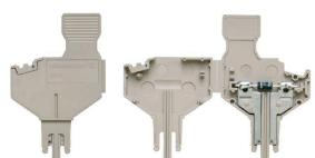
콤파넌트 플러그는 분리 단자대 블록에 전기 콤파넌트를 통합하는 데 사용됩니다. 전자 콤파넌트를 납땜한 후 플러그를 분리 단자대 블록의 분리 영역에 통합할 수 있으므로 분리 단자대 블록을 전자 부품이 통합된 모듈식 단자대로 변경합니다.
