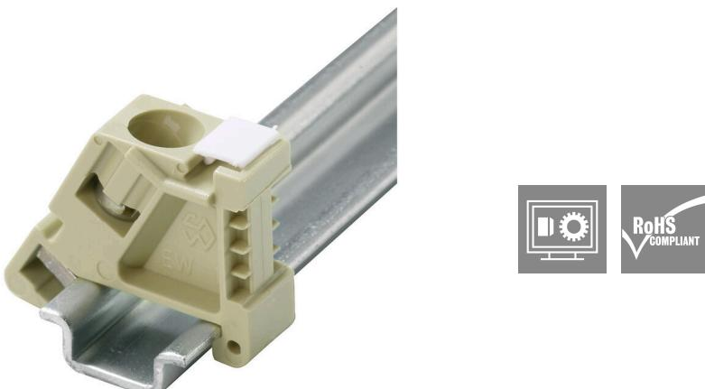
바이드뮬러 제품군에는 단자대 레일에 영구적이고 안정적으로 마운트될 수 있도록 보장하고 미끄러짐을 방지하는 엔드 브래킷이 포함되어 있습니다. 스크류가 포함 또는 포함되지 않은 버전을 사용할 수 있습니다. 엔드 브래킷에는 마킹 옵션(그룹 마커용 포함)과 테스트 플러그 홀더가 포함되어 있습니다.
