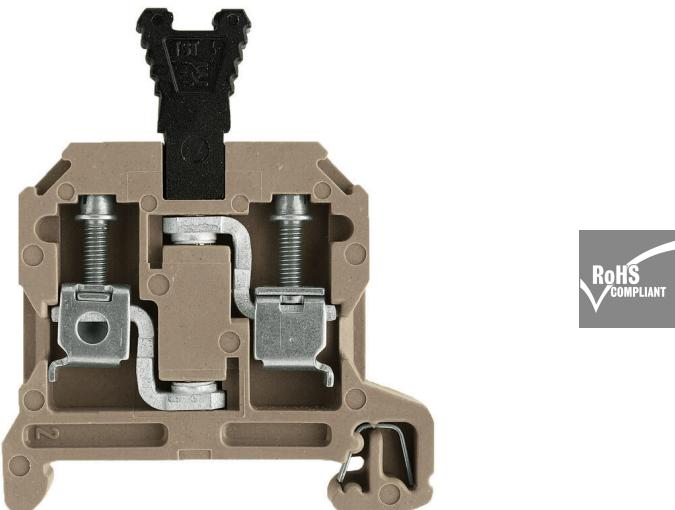
일부 응용 분야에서는 테스트 및 안전 목적을 위해 기본 연결 단자대에 테스트 포인트 또는 분리 요소를 추가하는 것이 좋습니다. 테스트 분리 단자대를 사용하여 전압이 없을 때 전기 회로를 측정할 수 있습니다. 분리 지점 이격 및 연면 거리는 치수와 관련하여 평가되지 않지만, 지정된 정격 임펄스 전압 강도를 입증해야 합니다.
