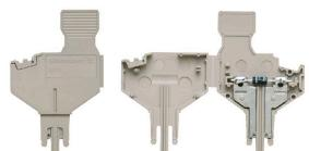
컴포넌트 플러그는 분리 단자대 블록에 전기 콤포넌트를 통합하는 데 사용됩니다. 전자 컴포넌트를 납땜한 후 플러그를 분리 단자대 블록의 분리 영역에 통합할 수 있으므로 분리 단자대 블록을 전자 부품이 통합된 모듈식 단자대로 변경합니다.
