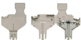
컴포넌트 플러그는 분리 단자대 블록에 전기 콤포넌트를 통합하는 데 사용됩니다. 전자 콤포넌트를 납땜한 후 플러그를 분리 단자대 블록의 분리 영역에 통합할 수 있으므로 분리 단자대 블록을 전자 부품이 통합된 모듈식 단자대로 변경합니다.
