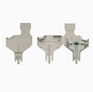
컴포넌트 플러그는 분리 단자대 블록에 전기 컴포넌트를 통합하는 데 사용됩니다. 전자 컴포넌트를 납땜한 후 플러그를 분리 단자대 블록의 분리 영역에 통합할 수 있으므로 분리 단자대 블록을 전자 부품이 통합된 모듈식 단자대로 변경합니다.
