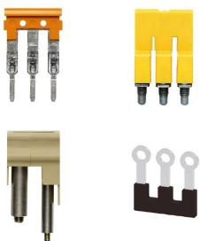
인접한 단자대에 전위를 분배 또는 증가시키는 것은 교차 연결을 통해 구현됩니다. 추가적인 결선 노력은 쉽게 피할 수 있습니다. 폴리 분리되더라도 단자대 블록의 접점 안정성은 여전히 보장됩니다. 당사의 포트폴리오는 모듈형 터미널 블록을 위한 플러그형 및 스크루형 점프바 시스템을 제공합니다.
