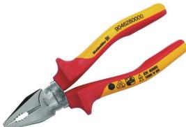
ライブ電圧を扱う場合は、特別なガイドラインに従い、特殊ツール - この使用目的のために特別に製造され、検査を受けたツール - を使用する必要があります。ワイドミュラーは、国内および国際試験基準に準拠したすべてのペンチのラインアップを提供しています。DIN EN 60900 準拠の製造および検査がすべてのペンチに対して実施されます。ペンチは手の形状に沿うよう、人間工学的に設計され、把持の位置取りが改善されます。指同士を押し付けないことで、操作時の疲労を軽減します。
