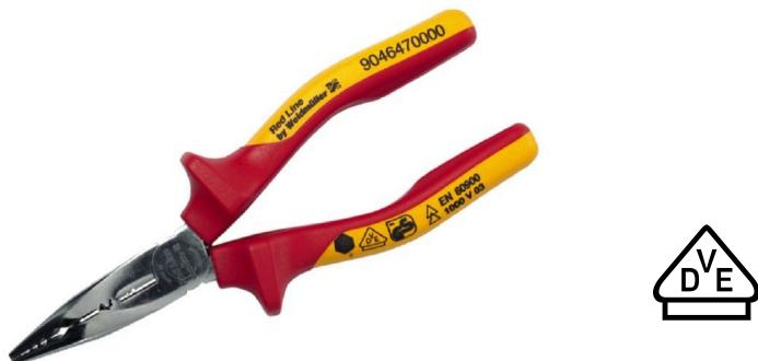
ライブ電圧を扱う場合は、特別なガイドラインに従い、特殊ツール - この使用目的のために特別に製造され、検査を受けたツール - を使用する必要があります。ワイドミュラーは、国内および国際試験基準に準拠したすべてのペンチのラインアップを提供しています。DIN EN 60900 準拠の製造および検査がすべてのペンチに対して実施されます。ペンチは手の形状に沿うよう、人間工学的に設計され、把持の位置取りが改善されます。指同士を押し付けないことで、操作時の疲労を軽減します。
