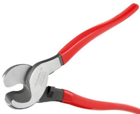
最大外径 8 mm、12 mm、14 mm、22 mm の導体対応カットツール。特殊形状の刃を使用すると、銅およびアルミニウム製の導体を、最小限の物理的な労力とピンチ不使用で切断できます。また切断工具(KT 8 ~ KT 22)には、EN/IEC 60900 に準拠した最大 1,000 V までの VDE および GS でテスト済みの保護絶縁材も付属します。
