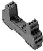
差し込み式 VSPC アレスタの基本要素。インピーダンスニュートラル VSPC BASE の基盤に PE フットを内蔵し、フローティングアース PE 接続は、統合火花放電ギャップを介して、最大 20 Ka (8/20 μs) および 2.5 Ka (10 / 350 μs) を PE へ安全に放電します。非接地信号回路に適合。
