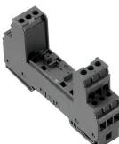
差し込み式 VSPC アレスタ用基本要素で、インピーダンス中立の VSPC BASE 内の統合された PE フットです。最大 20 kA (8 / 20 s)、2.5 kA (10 / 350 s) を PE に安全に放電できます。
