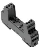
差し込み式 VSPC アレスタの基本要素。インピーダンスニュートラル VSPC BASE の基盤に PE フットを内蔵し、フローティングアース PE 接続は、統合火花放電ギャップを介して、最大20 kA (8/20 μs) および 2.5 kA (10 / 350 μs) を PE へ安全に放電します。非接地信号回路に適合。
