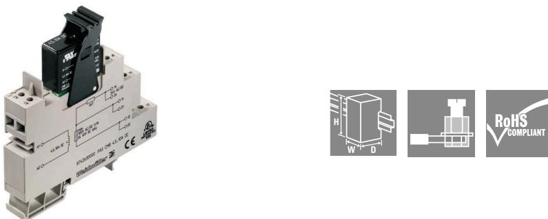
PLUGCONTROL PAS CMR は、直流電流を 10 A までモニタリングするシンプルで費用対効果に優れたソリューションを提供します。モニタリングリレー (REED 接点) は、標準ベースに取り付けられ、したがって TS35 DIN レールに取り付け可能です。バルブ、サーボ制御、DC モーターの電流モニタリングは、これらのモジュールの一般的なアプリケーションです。
