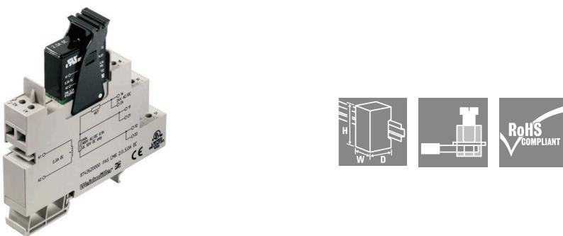
PLUGCONTROL PAS CMR は、直流電流を 10 A までモニタリングするシンプルで費用対効果に優れたソリューションを提供します。モニタリングリレー (REED 接点) は、標準ベースに取り付けられ、したがって TS35 DIN レールに取り付け可能です。バルブ、サーボ制御、DC モーターの電流モニタリングは、これらのモジュールの一般的なアプリケーションです。
