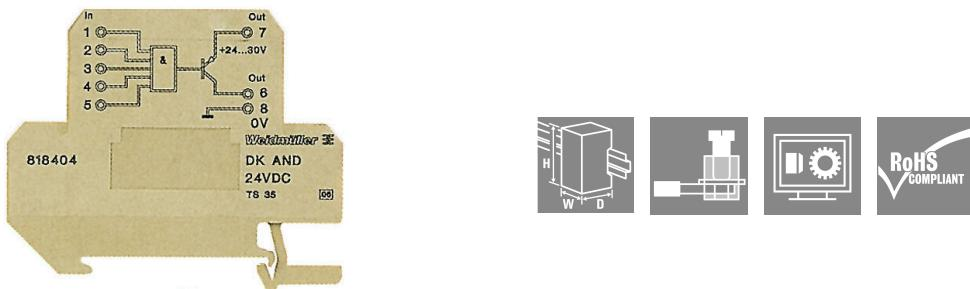
論理関数 AND、NAND、OR、NOR は、定格断面積 4 mm のモジューラー端子形式です。各入力は 5 つあり、24 V/20 mA の PNP 出力を介して論理ゲーティングで供給されます。このロジックコンポーネントは、デジタルセンサー / アクチュエータ信号と自動化装置とのカップリングを含む多くのアプリケーションに使用できます。
