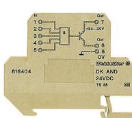
論理関数 AND、NAND、OR、NOR は、定格断面積 4 mm のモジューラー端子形式です。各入力は 5 つあり、24 V/20 mA の PNP 出力を介して論理ゲーティングで供給されます。このロジックコンポーネントは、デジタルセンサー / アクチュエータ信号と自動化装置とのカップリングを含む多くのアプリケーションに使用できます。
