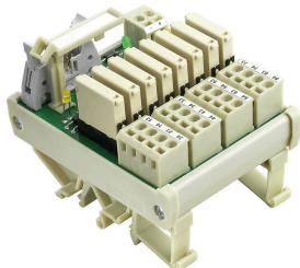
RS F40 または RS F10 インターフェースエレメント (32 または 8 シグナル対応) の使用により、リレーを使用して、センサーおよびフィールドアクチュエータを備えた PLC からの信号を絶縁できます。
